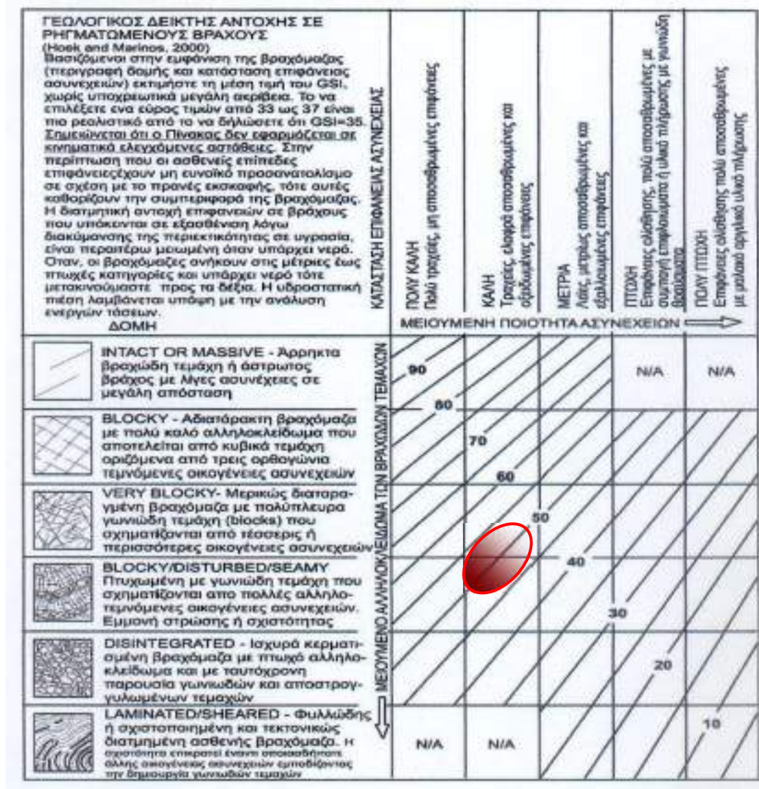
Σχ. 7.4-4: Βαθμονόμηση της βραχομάζας του ΨΑΜΜΙΤΗ βάση του Γεωλογικού Δείκτη Αντοχής (G.S.I.)
