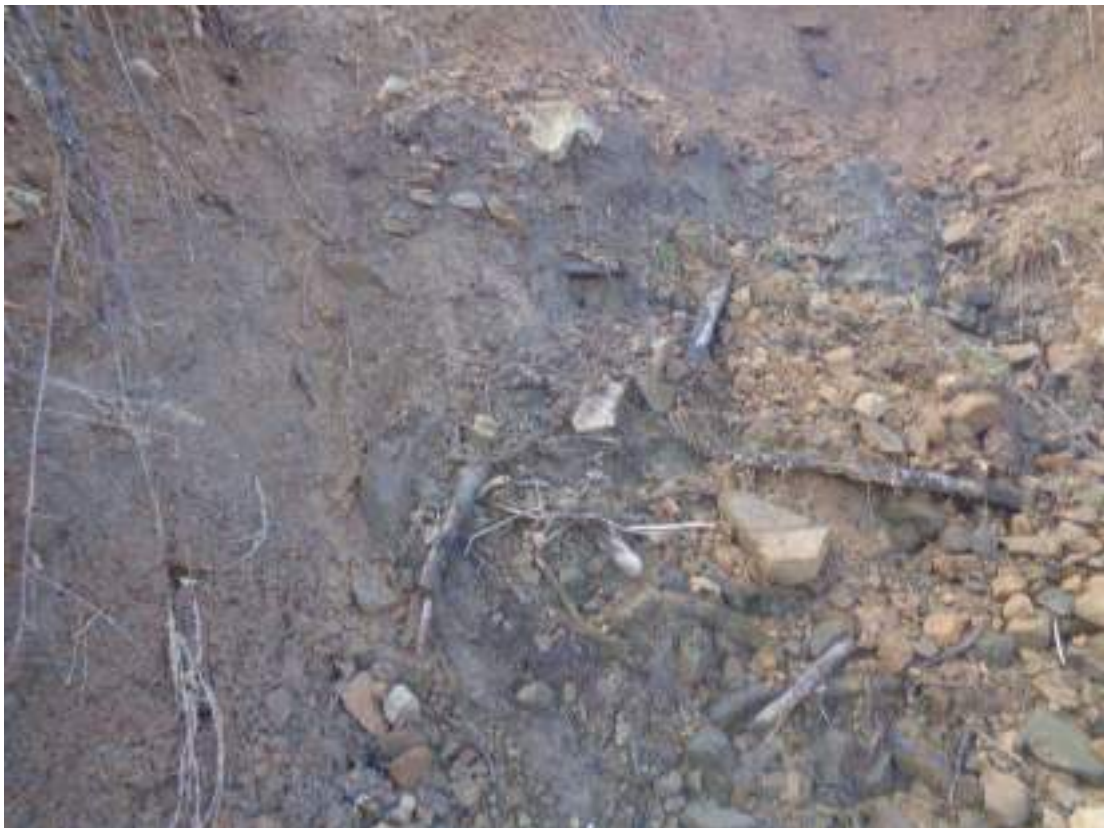
Φωτ. 17: Υλικά της κατολίσθησης που περιέχουν ξύλα, που δηλώνει ότι τα υλικά της κατολίσθησης ήτα υλικά επίχωσης από την διαμόρφωση στην φάση κατασκευής του χιονοδρομικού.
