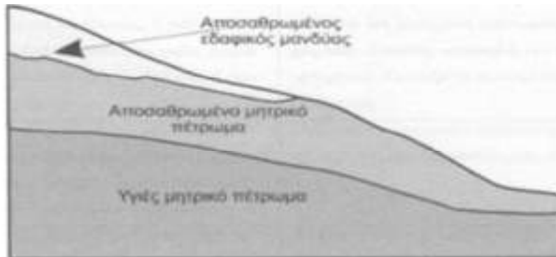
Σχήμα 3-2: Αποσάθρωση μητρικού πετρώματος και απόθεση του εδαφικού υλικού in Situ
