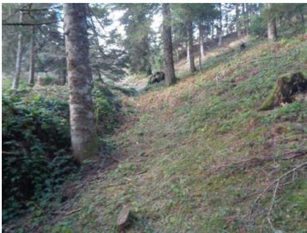
Φωτ. 11: Υλικά κατολίσθησης και τα έλατα έξω από την κατολίσθηση έχουν κατακόρυφο κορμό.
